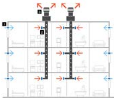
1. Entrées d'air 2. Soupapes d'extraction 3. Ventilateurs
